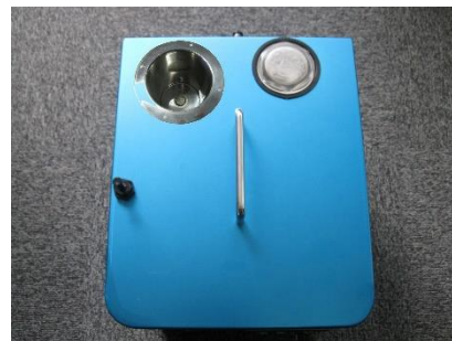
湿度校正器 HUM 湿度計校正用の試験槽が装置上部に設置してあります。
